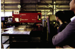
工場内部。レーザー加工機の動きが目をひく。自動的に鉄板を取り替えることで24時間、無人で加工を続けられるマシンもある。このマシンの加工精度が、階段の品質を支えている。
