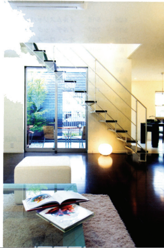
ノックダウン式直階段「オブジェア」。写真はトラスタイプで木段板と横さん手すりを使用。段板には他にガラスやパンチング、エンボスなどがある。
