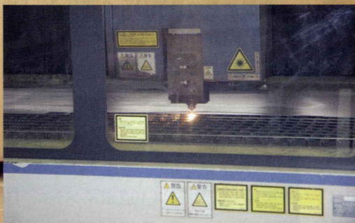
団地工場 レーザー加工機 スチール板は厚さ12mmまで加工可能
