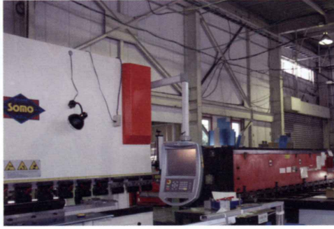
団地工場 板金設備 今年導入したイタリア製のプレスブレーキ
